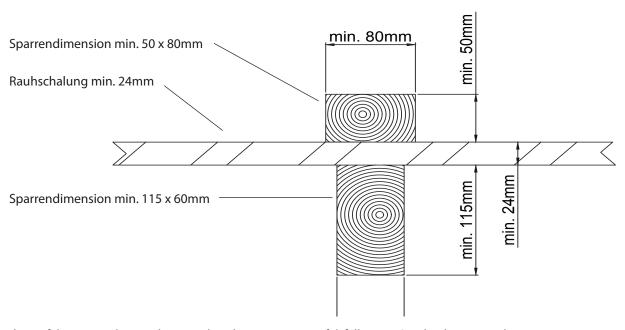
Es muss eine statisch tragfähige Unterkonstruktion vorhanden sein. Im Zweifelsfall ist ein Statiker hinzuzuziehen.
