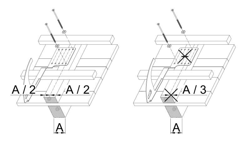
Richten Sie den Dachhaken so aus, dass die 2 Stk. mitgelieferten Befestigungsschrauben inkl. Fassonscheiben in der Mitte des Sparren, untereinander befestigt werden können. Je nach Höhe des Ziegels sind Höhenunterschiede durch biegen der Z-Kantung auszugleichen.
